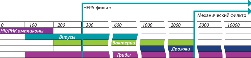
Рис. 2. Эффективность HEPA фильтрации относительно различных биологических объектов и их размеров, нм
